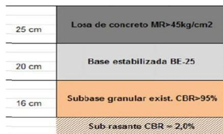
Ilustración 32 Composición de la sección de pavimento en ampliación de la vía principal.
