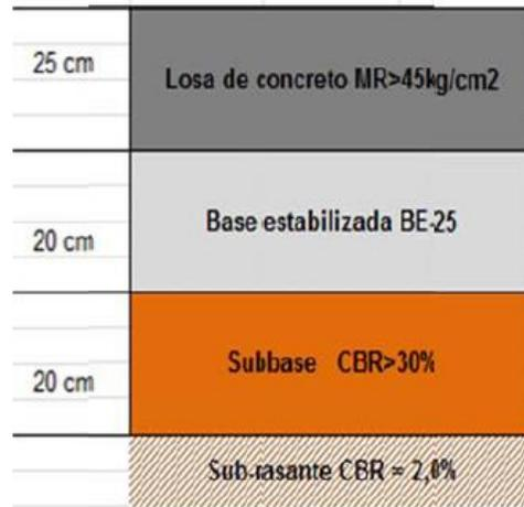
Ilustración 31 Composición de la sección de pavimento en ampliación de la vía principal.
